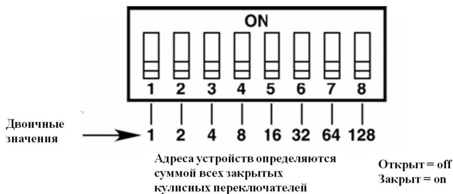
Рисунок 18 – Адресные переключатели извещателя
