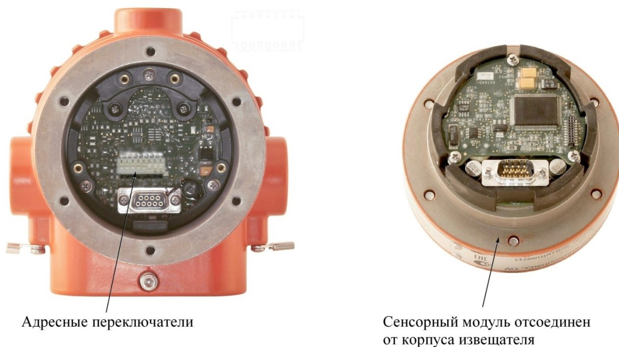
Рисунок 17 – Расположение адресных переключателей
